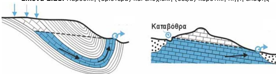
Εικόνα 2.22: Καρστική πηγή πλήρωσης ανερχόμενη (αριστερά) και καρστική πηγή πλήρωσης σε συνδυασμό με καταβόθρα (δεξιά)
